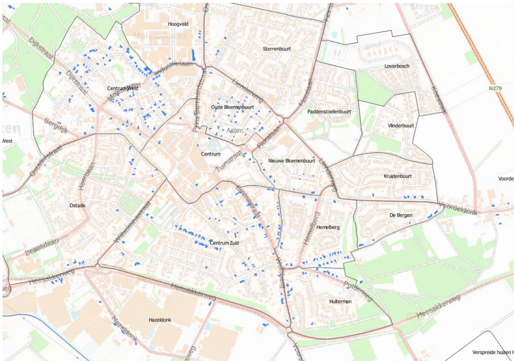
Figuur 4: woningen in Asten met bouwjaar > 1945 en energielabels E, F of G (data: DWTM/BAG, 2020) NB: een deel van deze woningen zal in de loop der jaren al grondig geïsoleerd/opgeknapt zijn en feitelijk een ander energielabel verdienen.
